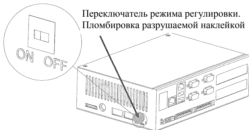
Рисунок 10 - Схема пломбировки от несанкционированного доступа средства измерений с электронным устройством, выполненным в виде промышленного компьютера (примеры различных компоновок)
